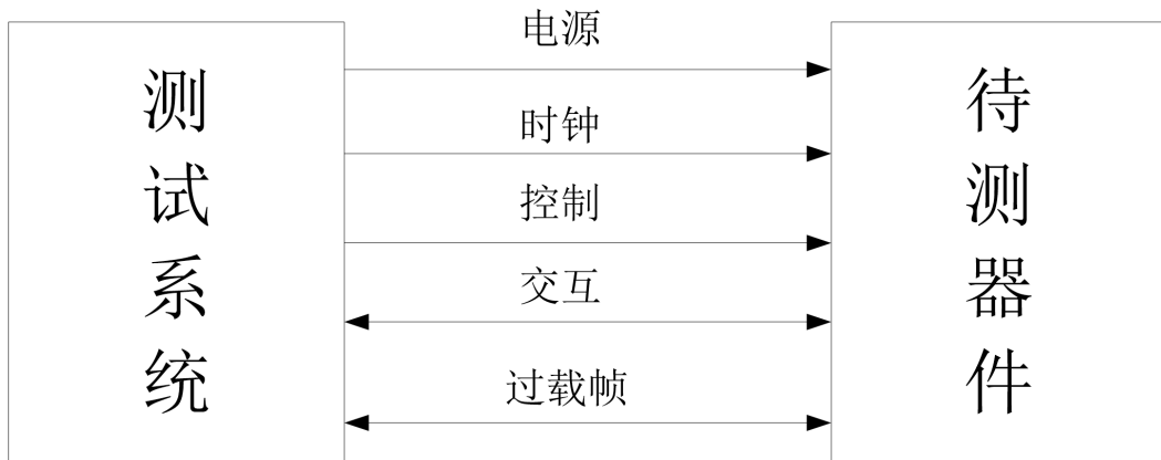
图5 过载帧发送验证原理图
