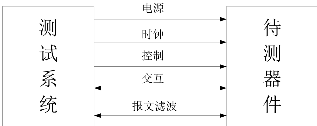
图7 报文接收滤波验证原理图
